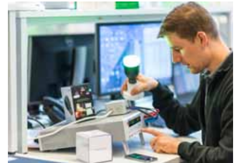
Forscher des iHomeLab an der Hochschule Luzern haben den Stromverbrauch von IoT-Geräten gemessen und berechnet. Im Bild: Wissenschaftler Lukas Kaufmann bei der Messung einer smarten LED-Lampe.
